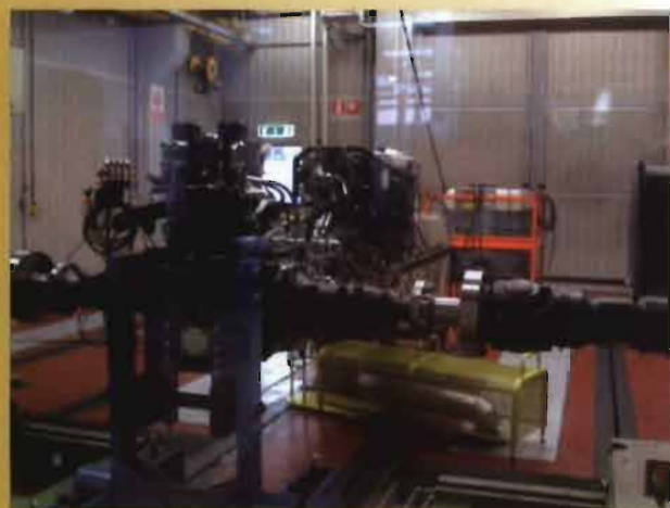
Banco para el ensayo de las transmisiones.
