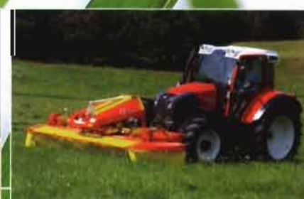
Cabezal Champion para tractor ancho de trabajo 1,25 - 3,00 m.
