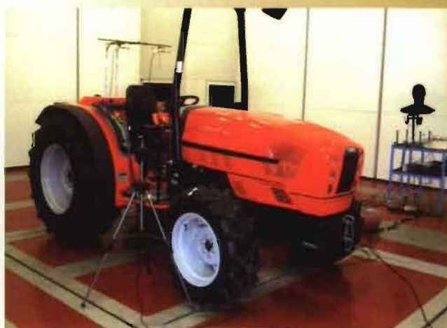
Medida del nivel sonoro en cámara semi-anechoica.
