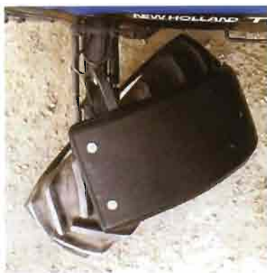
Los guardabarros dinámicos evitan su contacto con la carrocería y en el New Holland TM 150 permiten el aprovechamiento del giro incluso con diferentes configuraciones.
