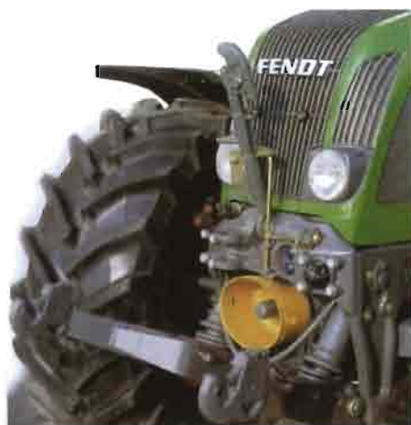
El Fendt es un tractor específicamente diseñado para operaciones que requieran el uso del enganche frontal junto con el trasero, algo también apreciable en la distribución de los controles en la cabina.
