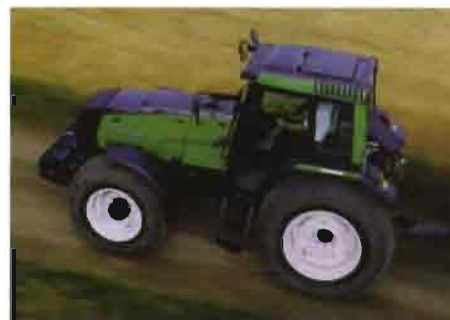
La anchura variable de la carrocería del Valtra de cara a mejorar la visibilidad lateral es un aspecto mejor aprovechado por otros fabricantes como John Deere y Case IH en sus series 8020 y MX Magnum.
