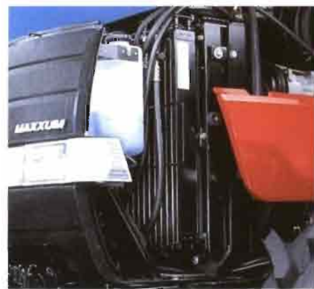
Si bien en el Case IH los paneles laterales son fácilmente desmontables, el control del nivel del líquido refrigerante se puede efectuar visualmente a través de la rejilla lateral perforada.
