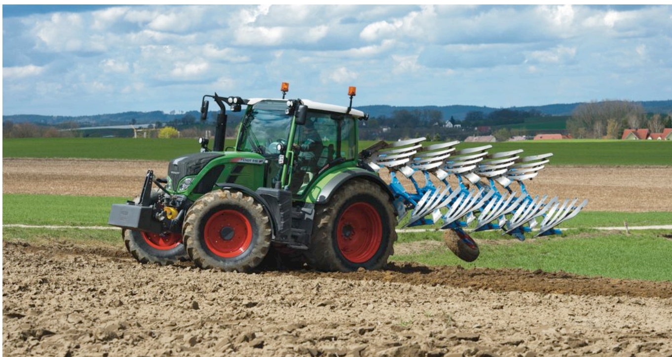
El mecanismo de elevación trasero incorpora compensación de carga.
