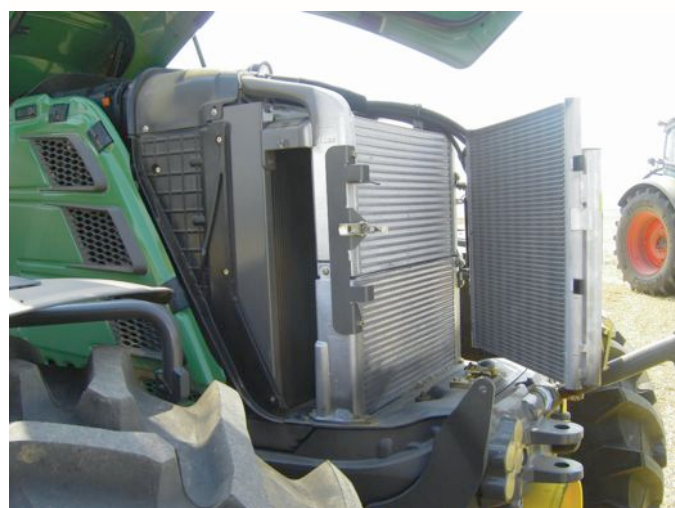
Fácil acceso a los radiadores para su mantenimiento
