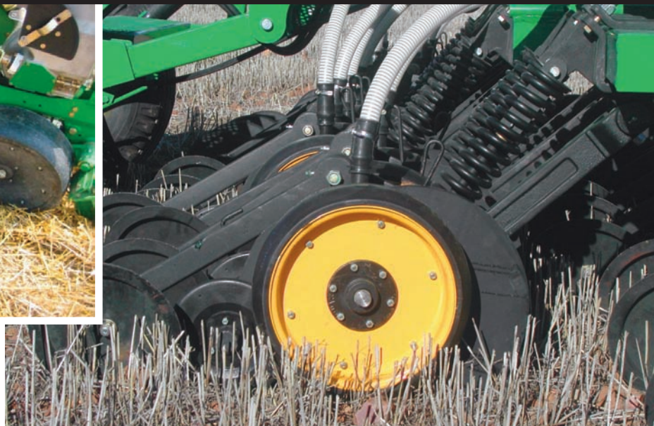
Sembradora Gil de siembra directa. Detalle de rueda limitadora de profundidad, rueda compactadora y tapadora
