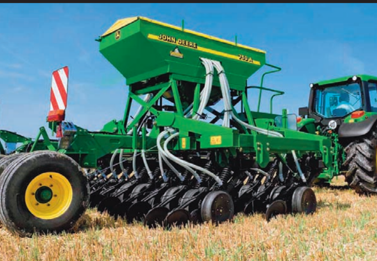
Sembradora de siembra directa neumática
