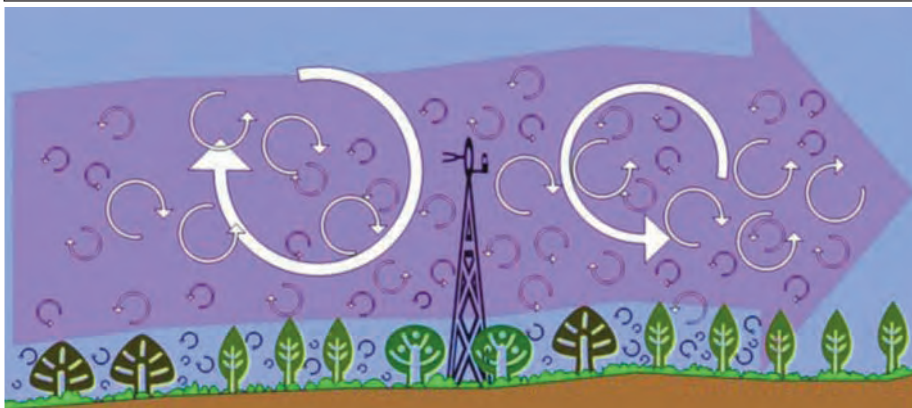
FIGURA 1 / Método Eddy covariance , aplicado en remolacha. Fuente: Aimcra
