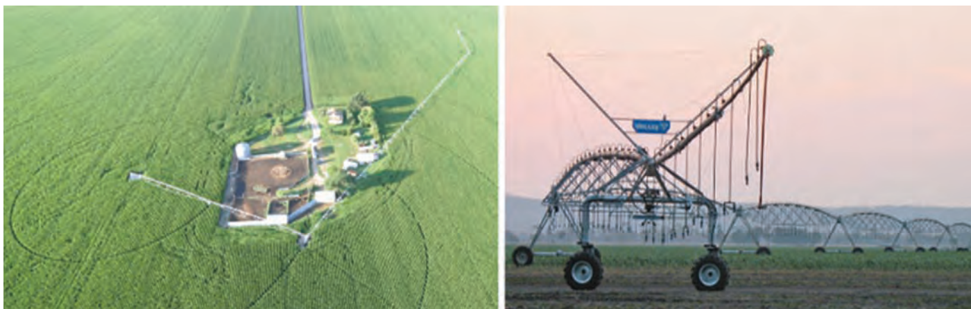
FOTO 4. A la izquierda Bender 160° doblándose ante la presencia de una granja. A la derecha, máquina Corner Valley®
