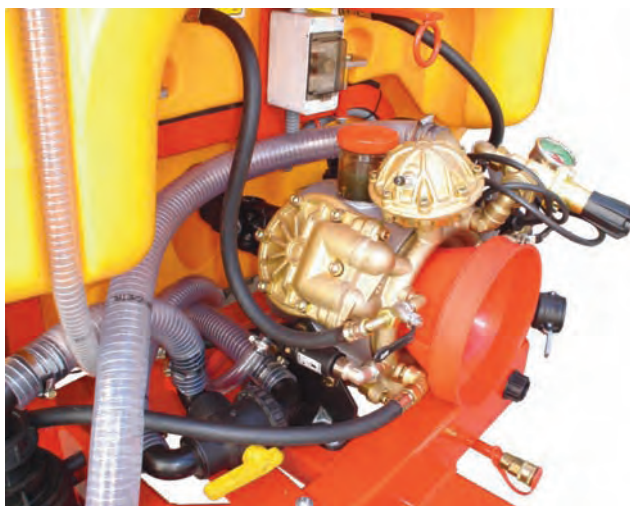
Detalle de la bomba, tuberías y toma de fuerza
