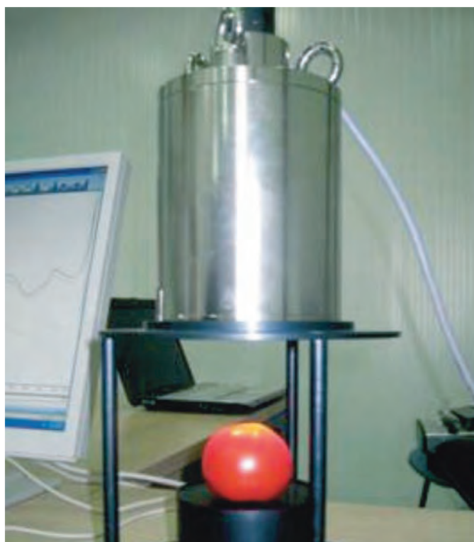
FOTO 1. Análisis de tomate realizado por el C.T. TECNOVA con un equipo Matrix-F de Broker
