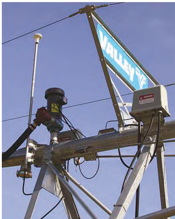
La antena GPS recoge los datos de posicionamiento de la máquina
