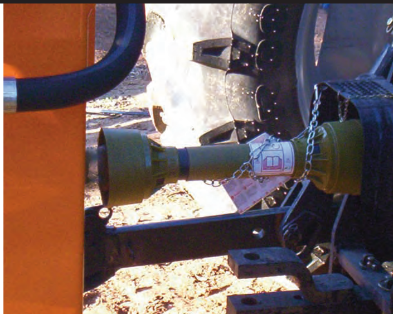
Eje cardán con señalización de seguridad
