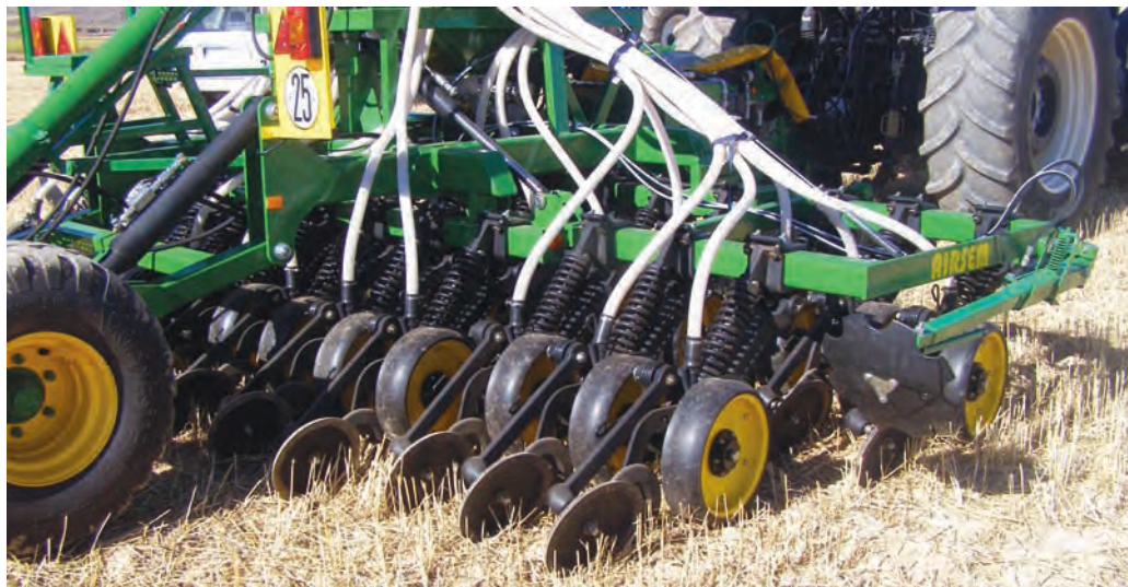
Siembra directa con sembradora de discos
