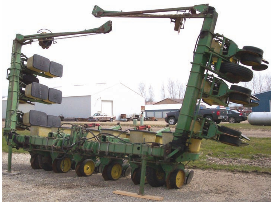
Sembradora de doce cuerpos arrastrada y plegada para transporte
