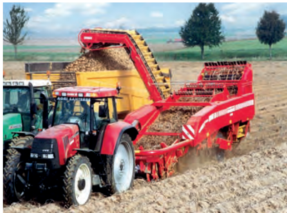
Recolectora arrastrada trabajando con remolque cargador en paralelo
