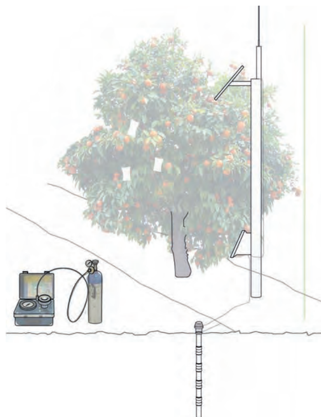
Esquema de la sonda instalada y equipo para la medida del potencial hídrico foliar
