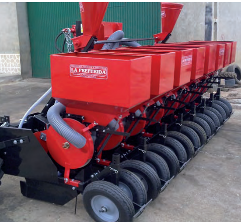
Sembradora neumática de 8 líneas
