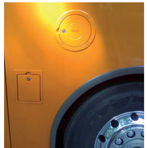
Autobús con depósitos de gasóleo y Adblue®
