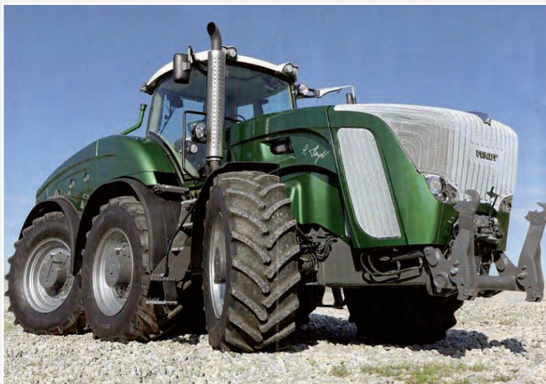
Tractor Fendt TRISIX, de 3 ejes y 540 CV
