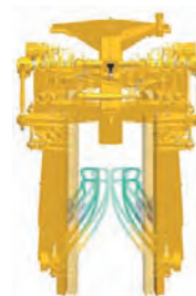
El Sistema Vari Width permite una adaptación perfecta a cada plantación desde el puesto de mando
