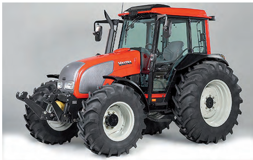
Tractor Valtra Serie A, 98 CV, 359 Nm con batalla de 2387 mm y altura máxima de 2660 mm
