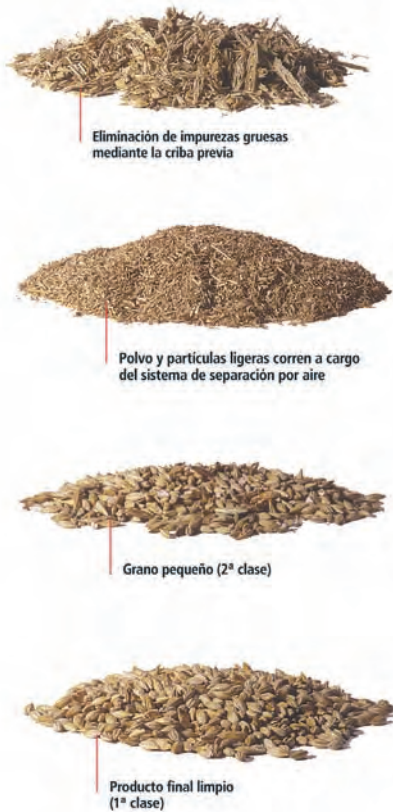
Figura 2: Resultado de la limpieza y clasificación con una máquina de la serie TAS (4 fracciones)
