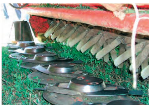
Detalle de discos con acondicionador de dedos
