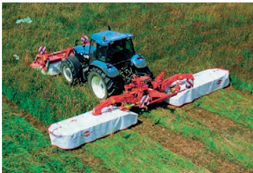
Segadoras en paralelo con hasta 9 m de ancho de trabajo
