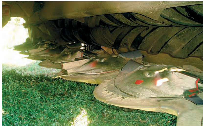
Detalle de discos con acondicionador de rodillos
