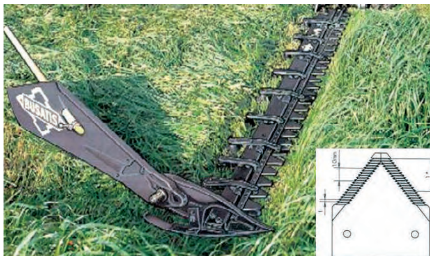
Barra de corte y detalle de cuchilla
