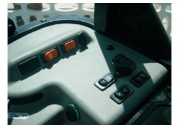
Pulsador del accionamiento del eje delantero
