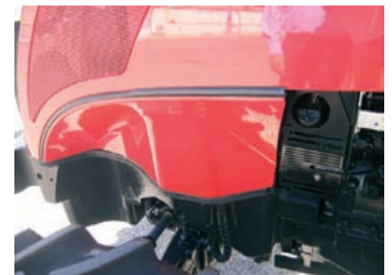
Diseño de bastidor "con cintura de avispa"
