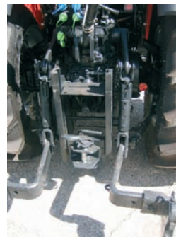
"Patines" con regulación electrohidráulica
