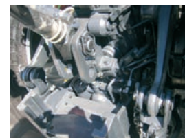
Control de esfuerzo en el 3 er punto
