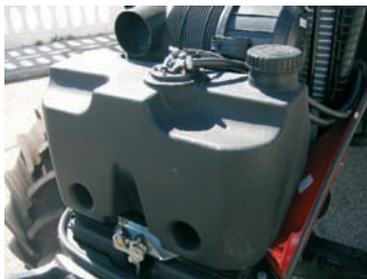
Depósito de combustible, F, S y V, versión cabina y arco
