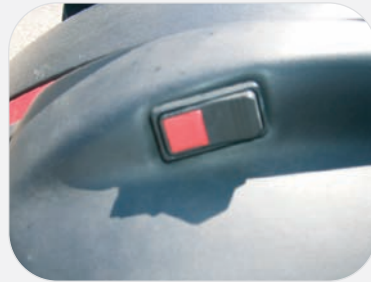
Pulsadores electrohidráulicos con posición de seguridad
