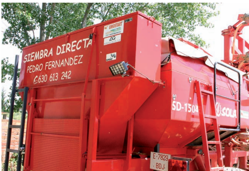
La tolva especial para el Umostart instalada en la sembradora
