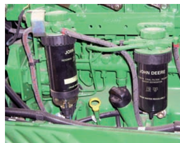
Filtros de combustible en serie. Varilla de nivel de aceite Acceso llenado de aceite
