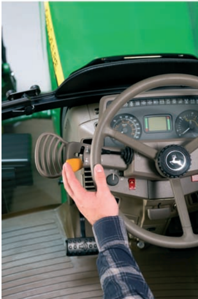
Inversor Electrohidráulico, permite realizar cambios de sentido sin pisar el embrague
