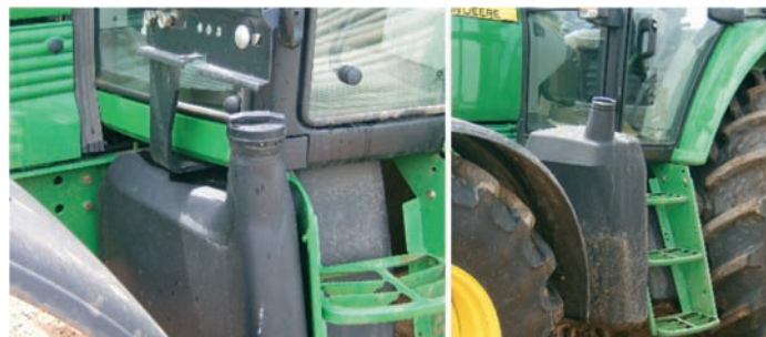
Depósito "pequeño" y "grande" de combustible
