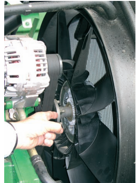
Ventilador del tipo viscoso fabricado en material plástico
