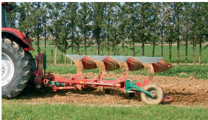
Arado de vertedera con volteo del suelo
