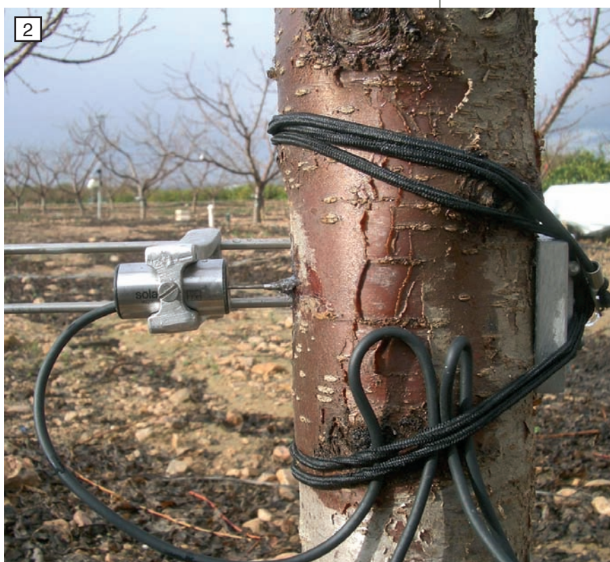
Detalle de la colocación del sensor LVDT y el portasensor sobre el tronco
