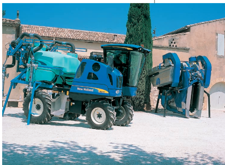
Los modelos VL y VX están preparados para realizar otras labores en el viñedo. Este equipo presenta, entre otras cosas, un nuevo sistema de nivelación y un brazo hidráulico de pulverizado.
