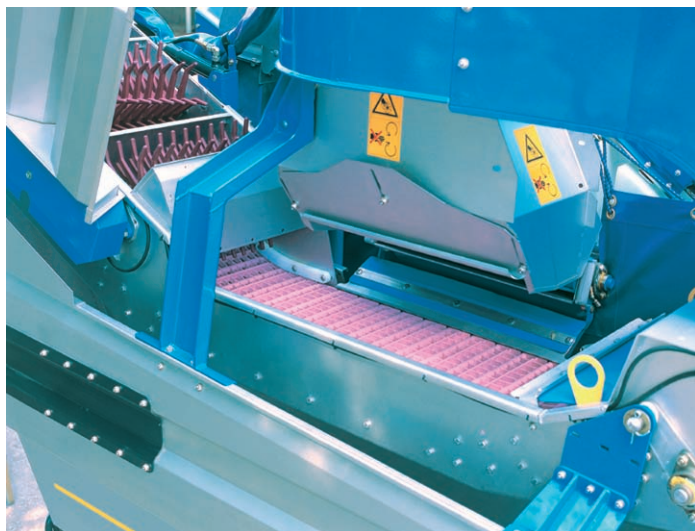
La despalilladora-separadora se coloca en la parte superior de cada tolva y permite mantener toda la capacidad de las mismas.
