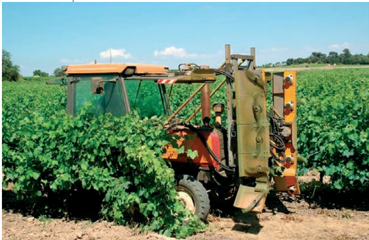
Despuntadora HME en trabajo
