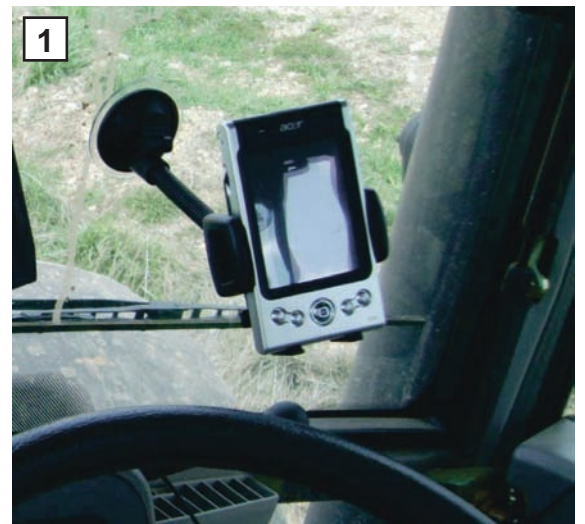
Instalación del Pocket-PC en el tractor mediante una ventosa de sujeción
