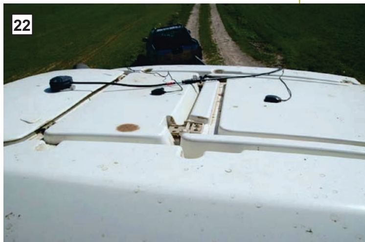
Posición de las antenas de los GPSs
