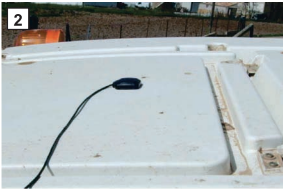
Antena GPS situada en la parte superior externa de la cabina
