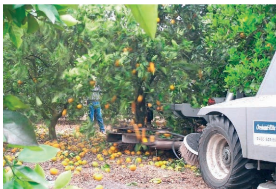
Recolección de fruta para industria con vibrador
