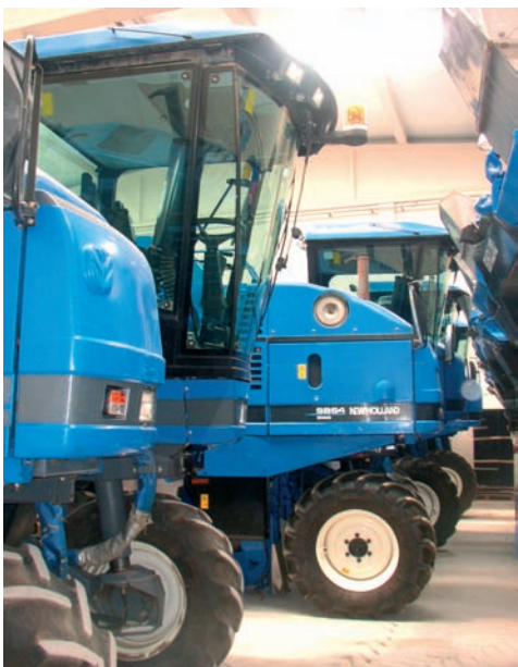
Modelos de la serie SB de New Holland utilizados para la recolección de la aceituna que permiten pasar por encima de alturas de olivo de más de 1,80 m
