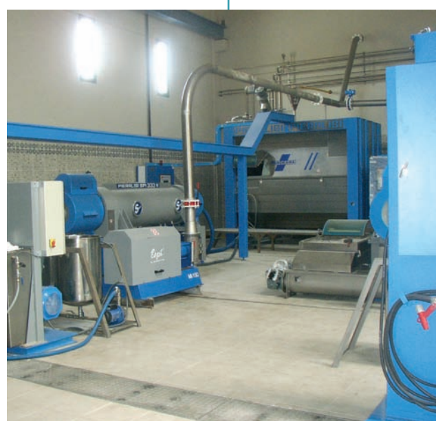
En esta imagen pueden apreciarse las dos batidoras (al fondo) y la centrifugadora junto a la pared
