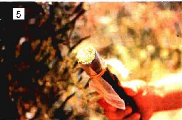
Restos de corolas que quedan en la malla que actúa como filtro en la boca de aspiración
