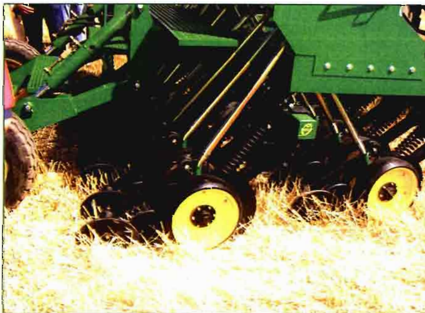
Ejemplo de sembradora de siembra directa de discos de Julio Gil
