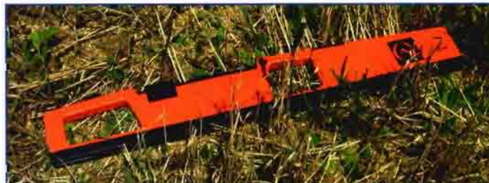
Sensor electromagnético EM38 en posición horizontal: Su lectura (valores de EMh) informa sobre la salinidad en el perfil de un metro de profundidad
