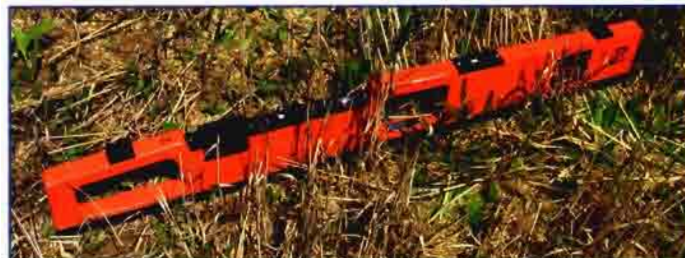
Sensor electromagnético EM38 en posición vertical: Su lectura (valores de EMv) informa sobre la salinidad en el perfil de dos metros de profundidad
