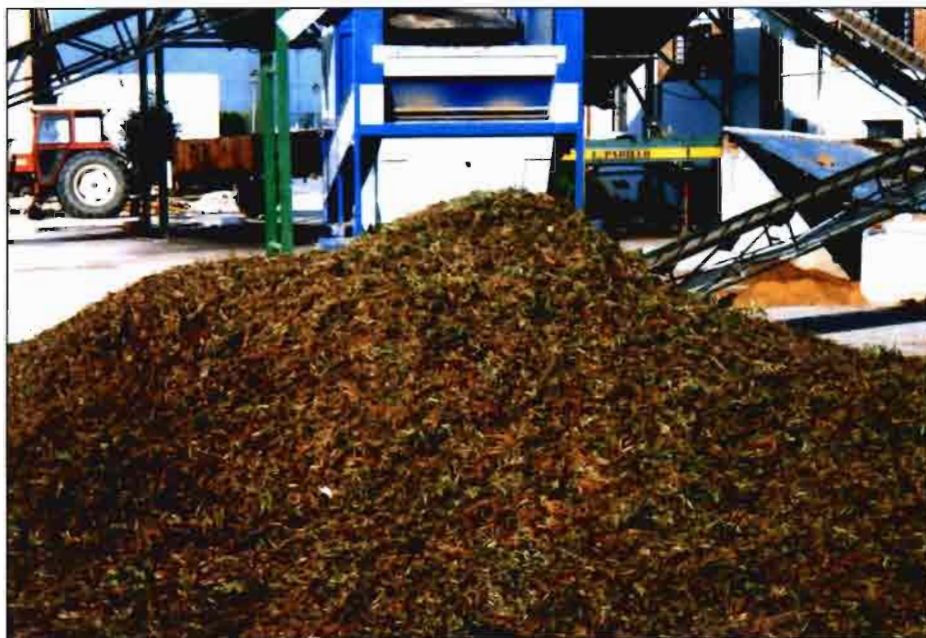
Maquina limpiadora de aceituna y montón de hoja separada en esta operación, en el patio de la almazara.
