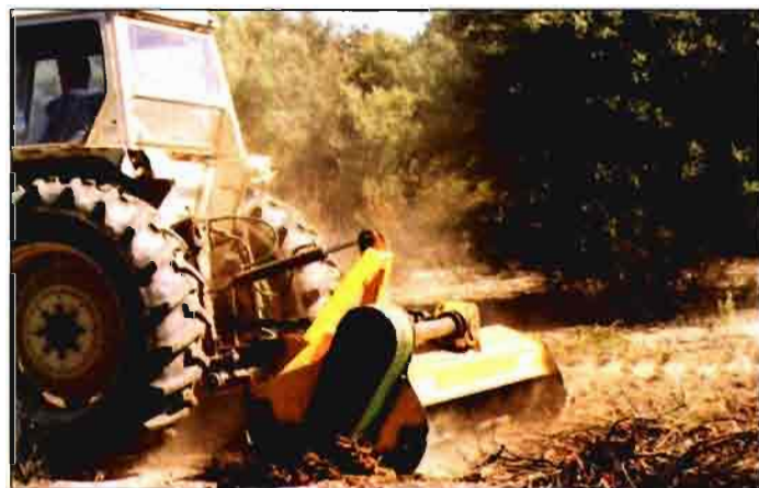
Desbrozadora accionada por tractor, modelo suspendido de la marca SERRAT (Talleres Serrat, Huesca).
