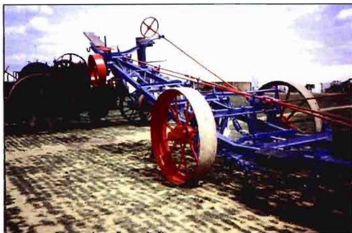
Arado para tracción por cable que fue base del laboreo motorizado de los años '30
