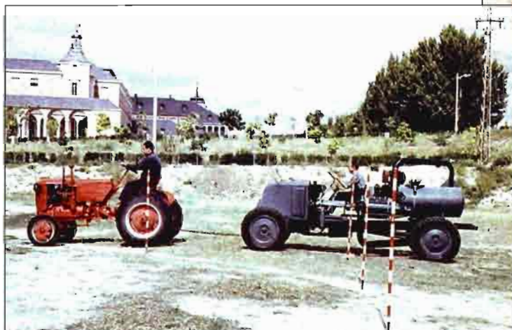
◀ Ensayo de tracción en las primitivas instalaciones de "Motocultivo" en La Moncloa
