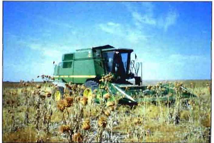
Recogida de la semilla con cosechadora de cereales (cabezal: girasol).
