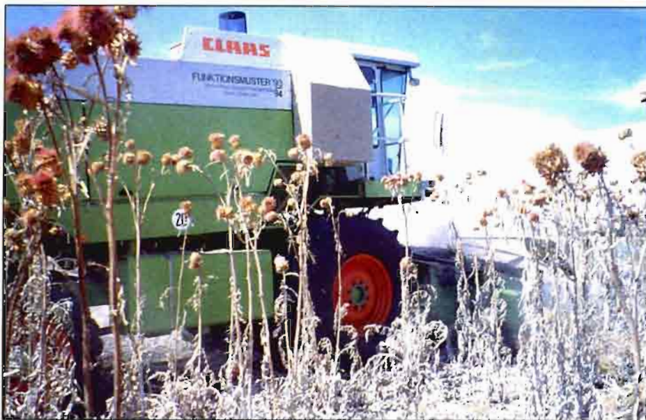
Prototipo de empacadora autopropulsada Claas trabajando sobre cynara.
