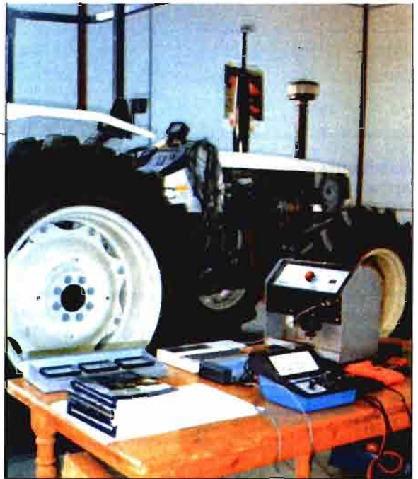
Instrumental utilizado en los ensayos: Caudalímetro, Tacómetro, Pistola estroboscópica, etc...
