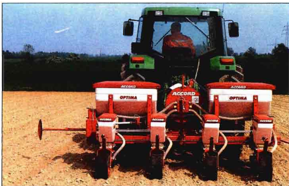
Sembradora para maíz de 4 hileras sobre un bastidor de 3 metros con aplicador de fertilizante.
