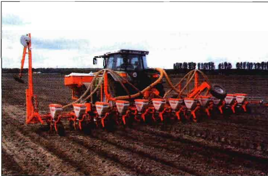
Sembradora de doce hileras para maíz, sobre bastidor de 9,3 m., con tolva delantera para aplicador neumático ACCORD de fertilizante DF2.
