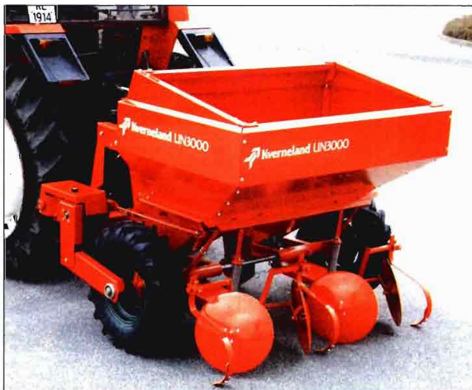
Figura 1: Plantadora de 2 hileras con discos aporcadores. Kverneland.
