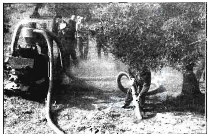
Entre las elevadoras neumáticas, para la recogida de aceitunas del suelo, se están desarrollando aspiradoras, cuyos prototipos se vienen presentando últimamente a los concursos y demostraciones internacionales organizados por el Ministerio de Agricultura.
