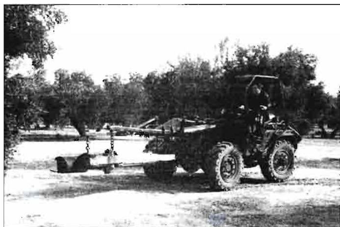
Vibrador multidireccional de masas excéntricas, utilizado en la Estación de la Venta del Llano de Mengibar (Jaén) para ensayos y prácticas de alumnos de la Escuela de Ingenieros Agrónomos de Córdoba.
