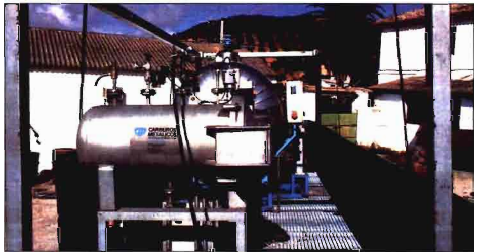
El equipo piloto para la eliminación de ácaros de productos curados viajó por toda España para demostrar a pie de fábrica su eficiencia.
