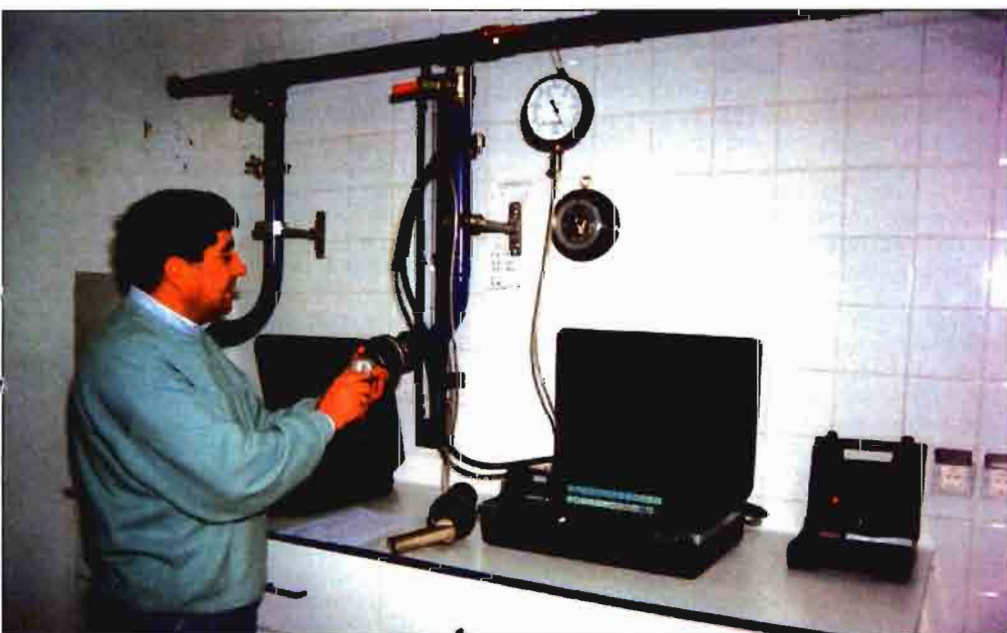
Técnico de la U.T.O. contrastando un medidor de caudal.
