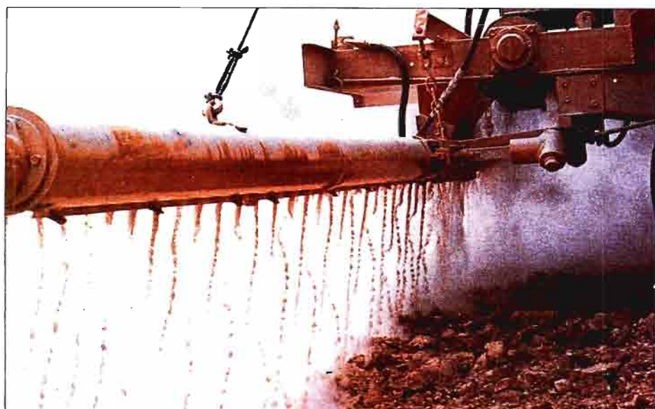
Distribución de ahorro con abonadora de caída por gravedad mediante tornillo sin-fin.
