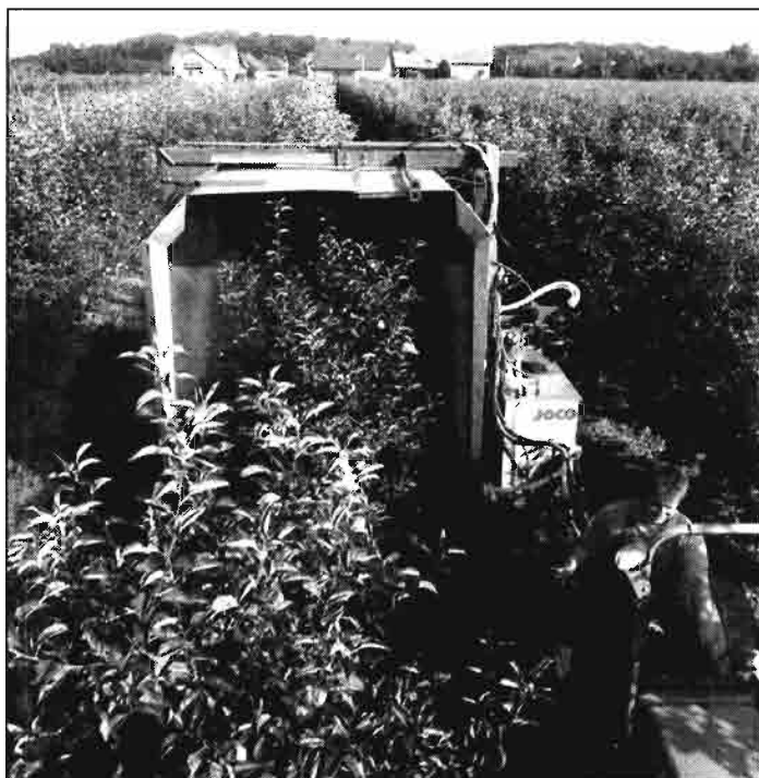
Túnel de pulverización con sistema de reciclaje de producto diseñado para el tratamiento de plantaciones de hasta 3,5 m de altura. Este dispositivo permite el ahorro de hasta un 50% de las dosis aplicadas con los equipos convencionales.
