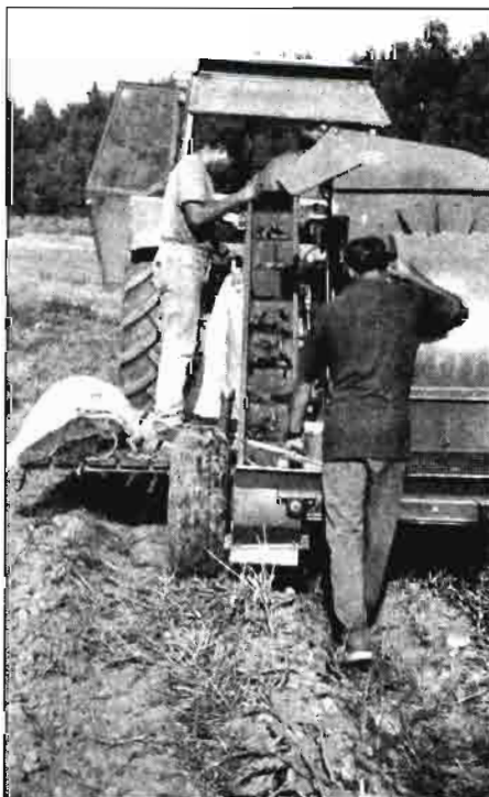
Ensayo de recolección mecánica con una cosechadora de judía verde sobre "Agridulce de La Vera" seleccionada y cultivada según las técnicas recomendadas.
