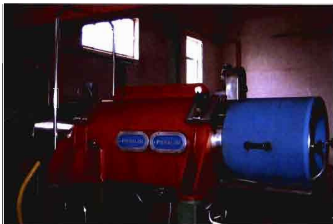
La mayor parte de las empresas fabricantes de sistemas continuos disponen de modelos de centrifugas horizontales de dos fases.
