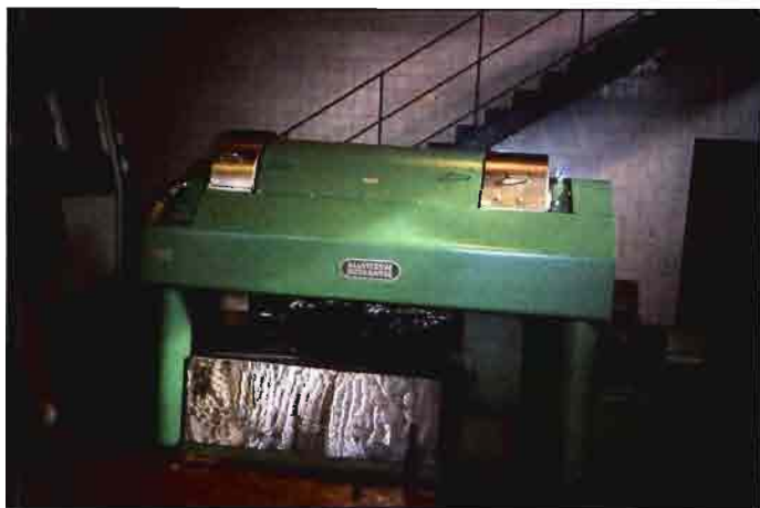
La mayor parte de las empresas fabricantes de sistemas continuos disponen de modelos de centrifugas horizontales de dos fases.
