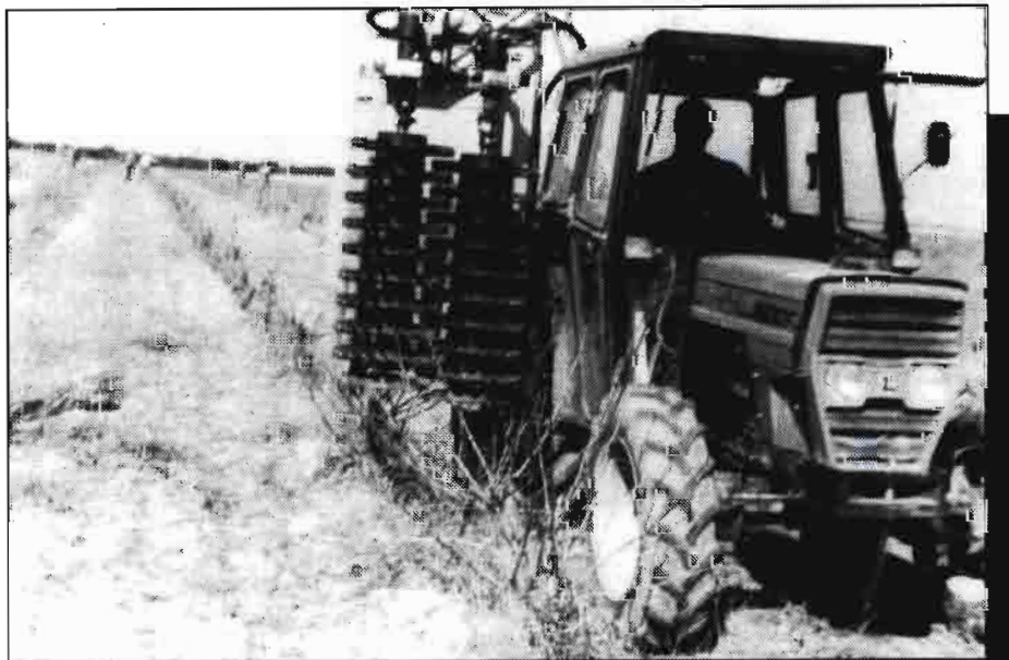
Podadora integral de platos horizontales cortantes.
