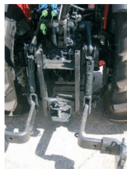
"Patines" con regulación electrohidráulica
