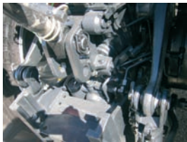
Control de esfuerzo en el 3º punto
