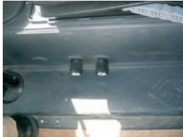
Pomo que regula la sensibilidad en el control de esfuerzo
