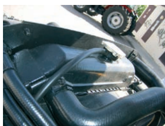
Tapón de llenado del líquido, tipo bayoneta
