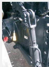
Palanca del régimen de giro
